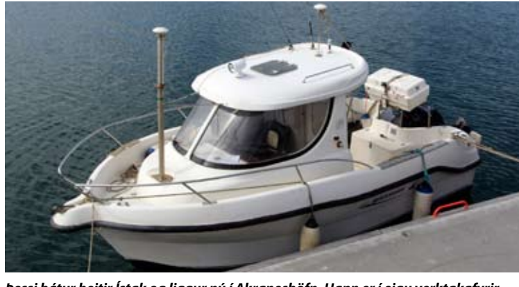
Þessi bátur heitir Ístak og liggur nú í Akraneshöfn. Hann er í eigu verktakafyrirtækisins með sama nafni og búinn fullkomnum staðsetningarbúnaði. Mikillar nákvæmni í staðsetningum er þörf þegar sjólögnin er lögð á hafsbotninn og þar gegnir þessi bátur lykilhlutverki.
